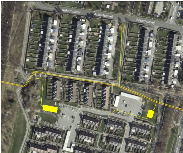
Billede 1: Etablering af ledninger og bassiner ved området Strandgården og Ankerhusene.
